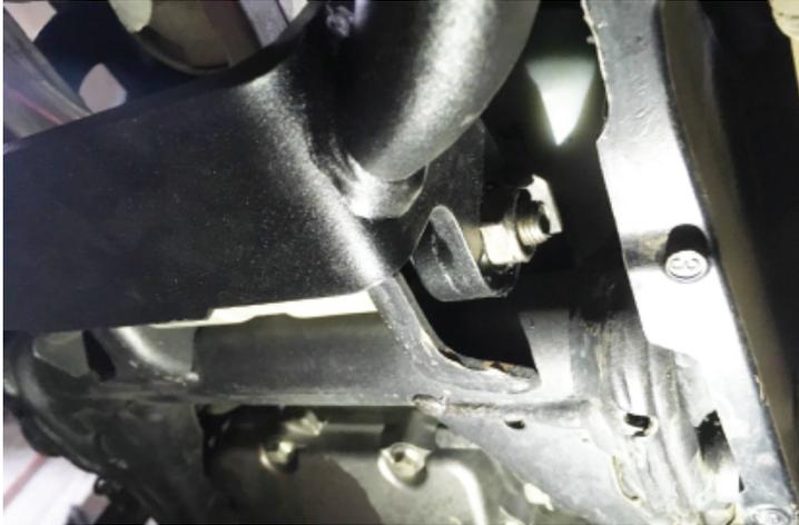
4. Dopo aver montato il supporto destro, allineare il lato sinistro con il foro di montaggio corrispondente.
