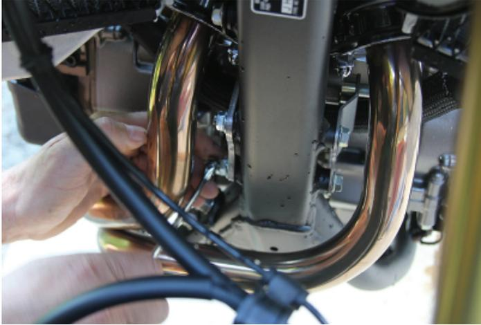
4. Posizionare il supporto trasversale delle barre di protezione.
