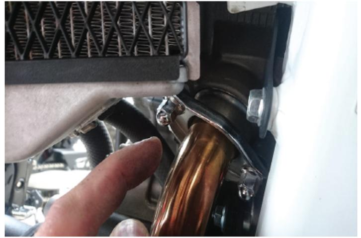
4. Con il collettore di scarico allentato è possibile rimuovere i bulloni che fissano le piastre di montaggio delle barre di protezione originali. Dopo averle rimosse, riassemble le parti superiori del collettore e reinserire il bullone passante superiore.
